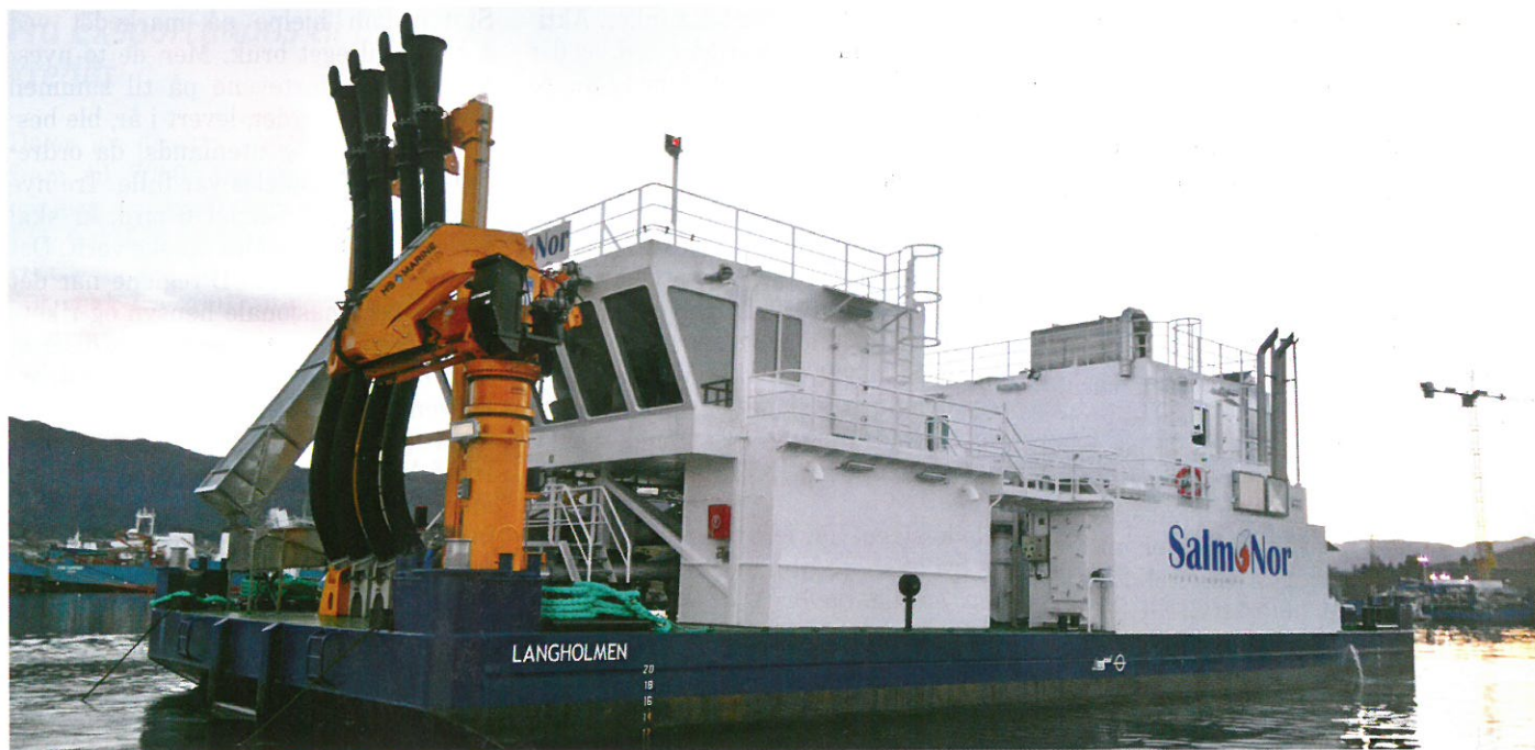
Satsinga på lektarar med avlusingsanlegg har vorte ei viktig nisje for Halsnøy Dokk. Totalt har dei levert fem anlegg. På bilete ser vi «Langholmen», utrusta med eit Hydrolicer-avlusingsanlegg. Den gjekk til Salmonor i Rørvik. Foto: Halsnøy Dokk
